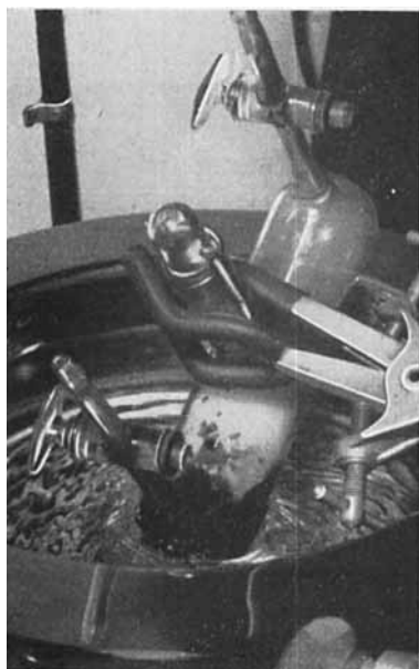
Abb. 3. Ultraschallbehandlung des Katalysators
